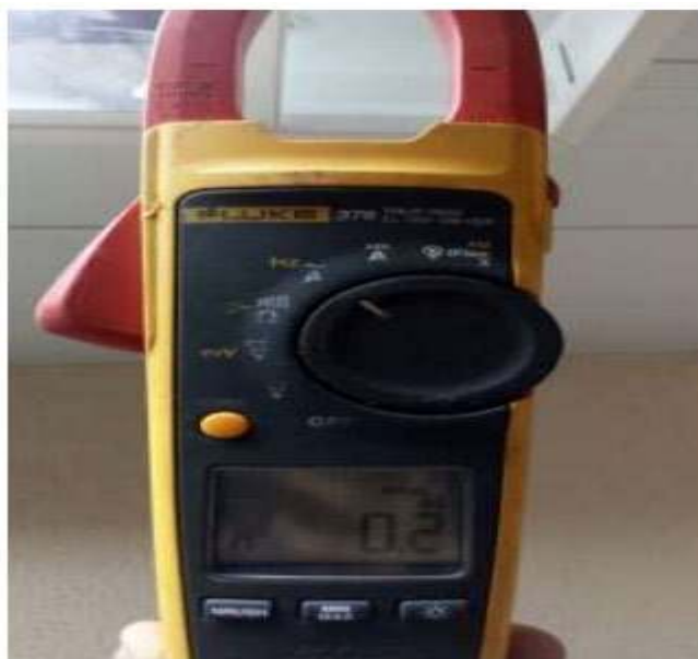
Figura 23. Imagem demonstra a medição de corrente elétrica nas duas lâmpadas de LED tubulares.
