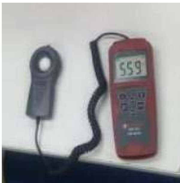
Figura 22. Imagem demonstra a maior medição de iluminância na sala informática.
