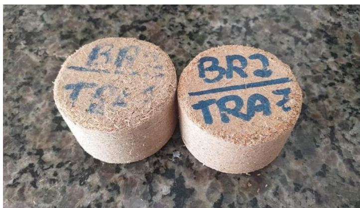
Figura 5. Comparação de desintegração entre um briquete 100% bagaço (esquerda) e um 50% bagaço 50% pinus sp. (direita).
