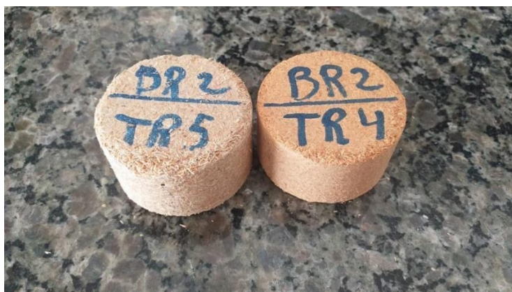
Figura 6. Comparação de desintegração entre um briquete 100% pinus sp. (direita) e um 50% bagaço 50% pinus sp. (esquerda).
