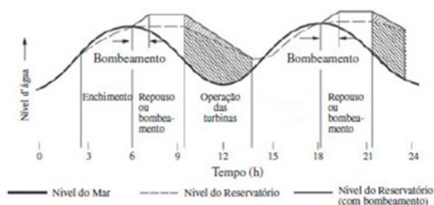
Figura 1. Representação da geração em maré vazante em uma usina maremotriz. Fonte: Leite Neto et al., 2011 [7].
